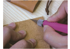
幅6mm／厚さ.5mmまでの市販のカッターナイフが使えます
