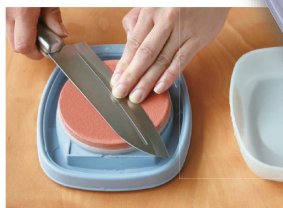
一定の動きで数回研ぎます。 (砥石と刃の角度はできるだけ一定に)
