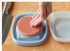
砥石に水をかけます。 (研ぎ作業中にも時々かけます)
